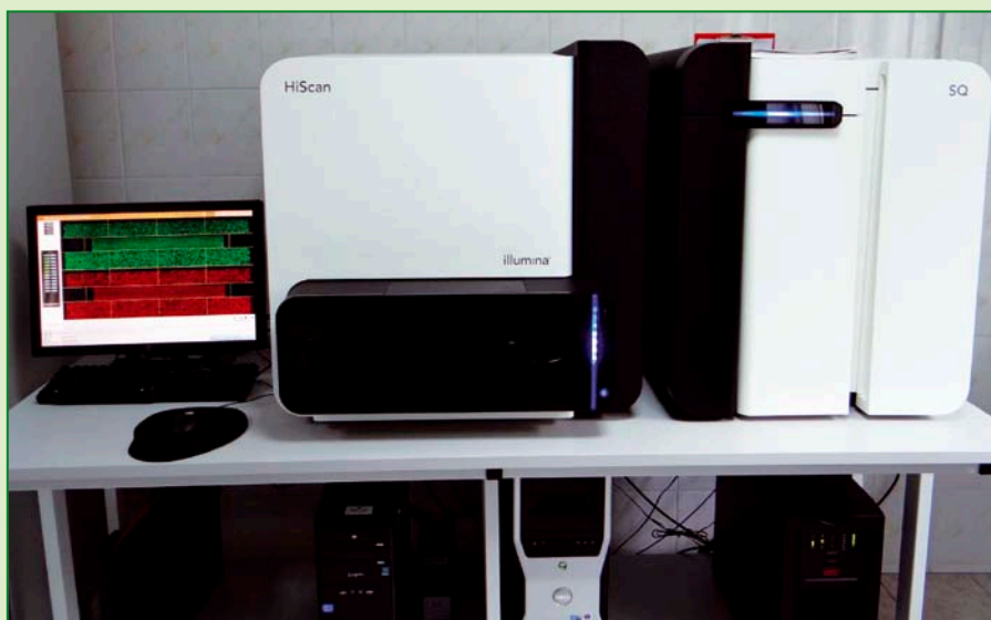
Skanowanie mikromacierzy SNP w aparaturze Illumina HiScanSQ.
