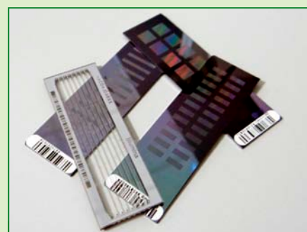
Mikromacierz ekspresyjna dla myszy, mikromacierze SNP dla bydła i psa oraz flowcell do sekwencjonowania firmy Illumina.
